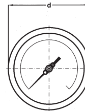
D - Ungefüllte Ausführung : Anschluss exzentrisch hinten für Direktmontage
